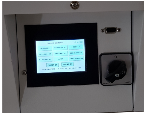
По желанию заказчика заторный аппарат может быть оснащен цветным сенсорным экраном.
