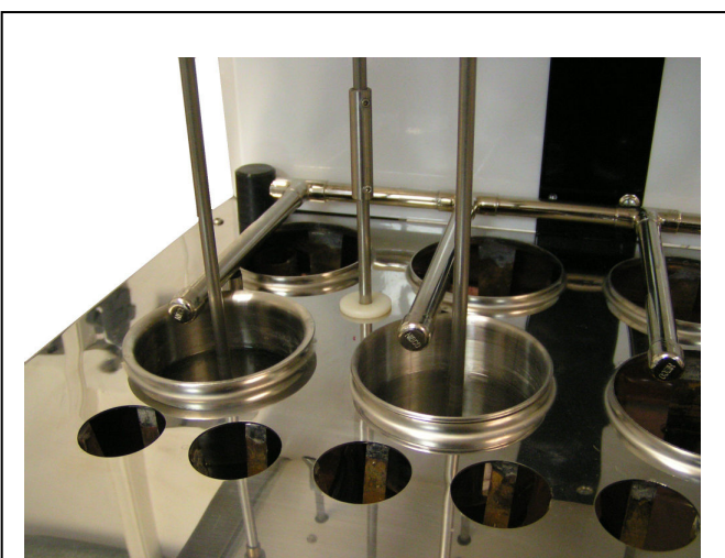
Détail sur les buses d'ajout automatique d'eau distillée
