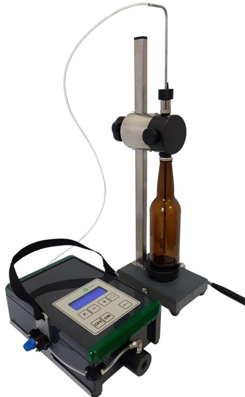
Возможность использования прибора для определения растворенного кислорода в лабораторных условиях, для отбора пробы в лаборатории из бутылки с напитком в качестве принадлежностей предлагается пробоотборник тип ICAS.
