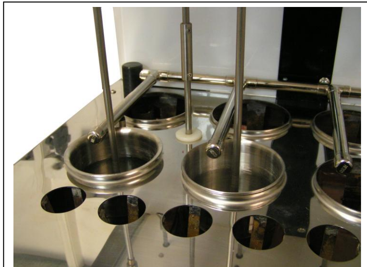
Szczegóły dysz automatycznego dozowania wody destylowanej
