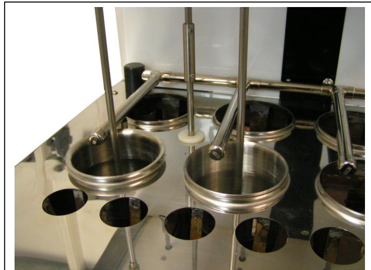
Detail der Düsen für die automatische Nachfüllung mit destilliertem Wasser
