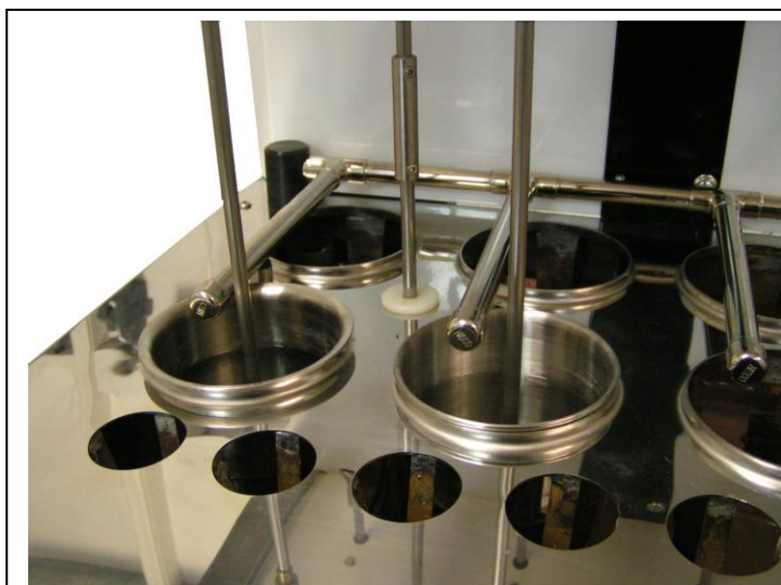
Detail trysek automatického doplňování destilovanou vodou
